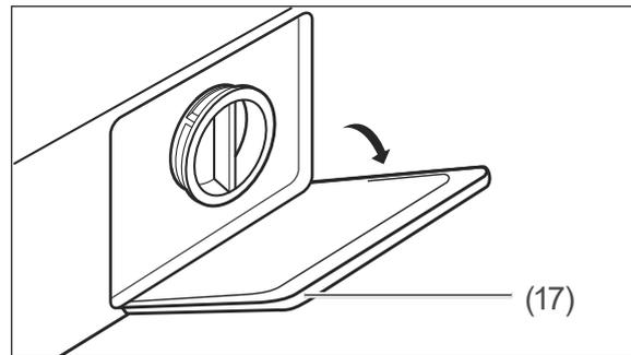
3. Öffnen Sie die Blende (17) der Fremdkörperfalle vorsichtig mit einem flachen Gegenstand, z. B. einem Schlitzschraubendreher.
