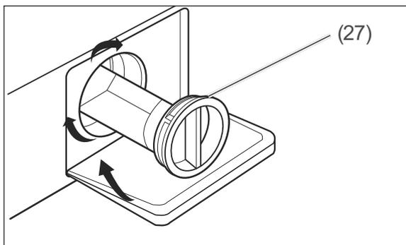
8. Setzen Sie die Fremdkörperfalle (27) wieder ein, und schrauben Sie sie bis zum Anschlag fest.
