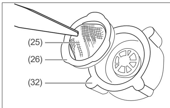
6. Ziehen Sie das Sieb (25) mit der Dichtung (26) mithilfe einer Pinzette oder Zange aus der Überwurfmutter (32) heraus. Spülen Sie das Sieb unter klarem Wasser ab und reinigen Sie es ggf. mit einer kleinen, weichen Bürste.
