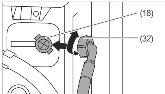
1. Schrauben Sie den beiliegenden Wasser-Zulaufschlauch handfest am Anschlussstutzen (18) fest. Drehen Sie dazu die Überwurfmutter (32) im Uhrzeigersinn.
