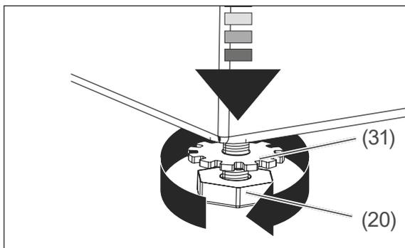
1. Lösen Sie die Kontermutter (31) eines Schraubfußes (20) auf der Geräte-Unterseite.
