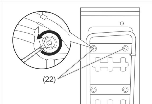
1. Lösen Sie die Schrauben der Transportsicherungen (22) mit einem 10er-Schraubenschlüssel.
