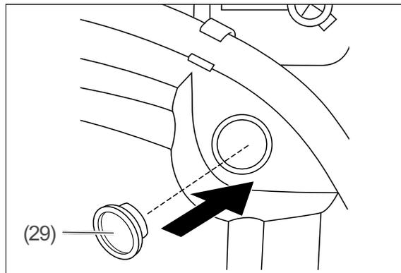
3. Verschließen Sie die Öffnungen mit den beiliegenden Abdeckungen (29).
