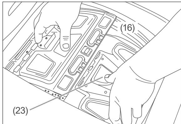
3. Zum Öffnen der Waschtrommel (16) drücken Sie die Kunststoffnase (23) an der kleineren Deckelhälfte etwas nach unten, bis die Verschlusshaken ausrasten.
