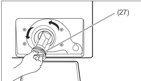
4. Stellen Sie einen passenden Auffangbehälter unter die Fremdkörperfalle (27).
