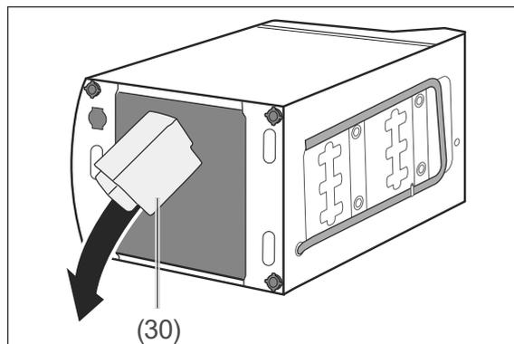
5. Kippen Sie das Gerät vorsichtig auf die Seite, und überzeugen Sie sich, dass die Styroporsicherung (30) ebenfalls entfernt ist. Sollte sie noch in der Aussparung im Boden des Geräts stecken, entfernen Sie sie.
