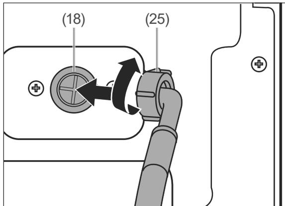
5. Schrauben Sie den Wasser-Zulaufschlauch vom Gerät ab.
