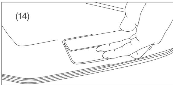
1. Öffnen Sie den Gerätedeckel (14), indem Sie unter den Griff fassen und den Deckel nach oben klappen.
