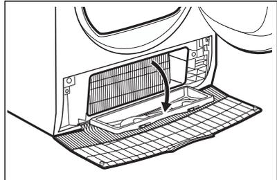
5. Entfernen Sie nach Bedarf die Flusen aus dem Kondensator und seinem Fach. Sie können einen Staubsauger mit Bürstenaufsatz verwenden.
