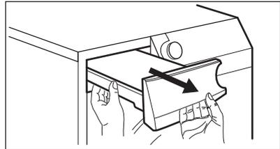
2. Ziehen Sie die Kunststoffverbindung heraus und entleeren Sie das Wasser in ein Waschbecken oder ein zweckmäßiges Behältnis.
