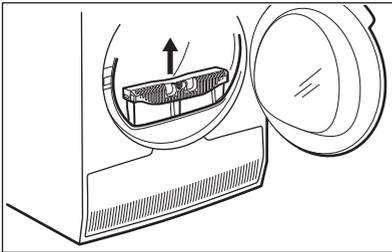
2. Öffnen Sie die Kondensatorabdeckung.
