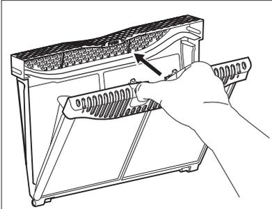
3. Entfernen Sie die Flusen von den beiden inneren Teilen des Filters mit der Hand.
