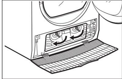
4. Klappen Sie den Kondensatordeckel nach unten.
