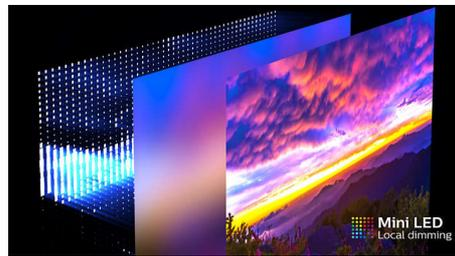
Die Mini-LED-Hintergrundbeleuchtung verbessert die Steuerung von Beleuchtung und Kontrastverhältnis. Die kleine Größe der Mini-LEDs, die die Hintergrundbeleuchtung bilden, ermöglicht die Erstellung von 1.152 individuell steuerbaren Zonen, wodurch tiefere
