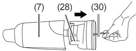
2. Klappen Sie den Drahtgriff (30) des Filtergehäuses aus und ziehen Sie das Filtergehäuse (28) daran aus dem Staubbehälter (7) heraus.
