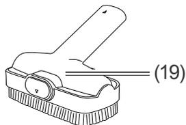
Die 2-in-1-Düse ist geeignet, um Staub von Schränken, Regalböden oder Fensterbrettern sowie aus Polstern zu saugen. Sie kann an den jeweiligen Verwendungszweck angepasst werden:
