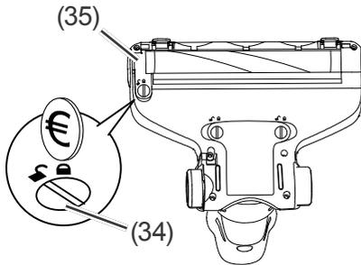
1. Drehen Sie mithilfe einer kleinen Münze den Schlitz der Verriegelung (34) der Halterung (35) auf die Position
