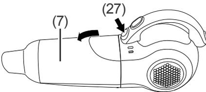
1. Entriegeln Sie den Staubbehälter (7) durch Drücken der Entriegelungstaste (27), und nehmen Sie ihn ab.
