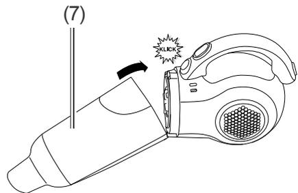
9. Setzen Sie den Staubbehälter (7) wieder auf den Motorblock und lassen Sie ihn mit einem hörbaren Klick einrasten.
