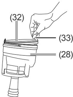
5. Ziehen Sie den Motorschutzfilter (32) an der Lasche (33) aus dem Filtergehäuse (28).
