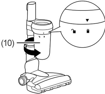
1. Drehen Sie den Staubbehälter (10) **im Uhrzeigersinn**, bis das Symbol
