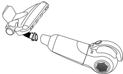
3. Ziehen Sie nun das Schlauchende nun aus der Universal-Bodendüse heraus, und saugen Sie den Schlauch aus.
