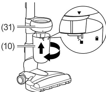
1. Setzen Sie den Staubbehälter (10) so auf den Halter (31), dass das Symbol
