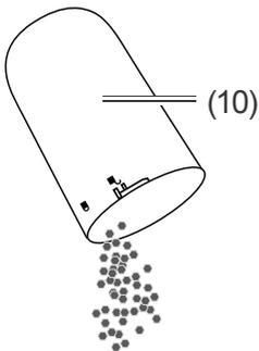
2. Entleeren Sie den Staubbehälter (10) im Freien über einer Mülltonne.
