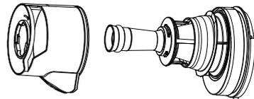
Zum leichteren Reinigen lässt sich das durchsichtige Kunststoffteil des Filtergehäuses abnehmen (zum Abnehmen links herum drehen, zum Anbringen rechts herum drehen).
