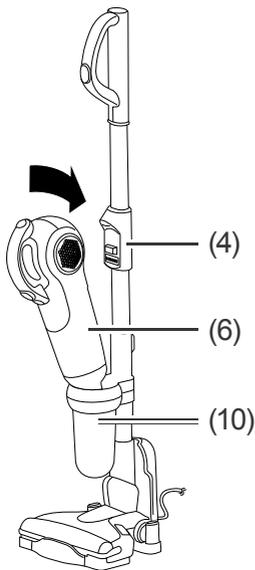
4. Stecken Sie das Handgerät (6) in die Aufnahme des Staubbehälters (10) am unteren Geräte-
