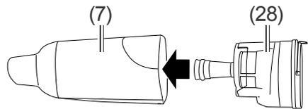
8. Schieben Sie das Filtergehäuse (28) in den Staubbehälter (7) zurück.
