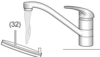
6. Reinigen Sie den Motorschutzfilter (bei Bedarf unter fließendem Wasser und lassen Sie ihn völlig durchtrocknen).
