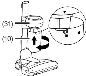
3. Setzen Sie den Staubbehälter (10) so auf den Halter (31), dass das Symbol
