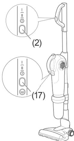
1. Drücken Sie entweder den Ein-/Aus-schalter (2) oder (17), um das Gerät einzuschalten (Saugstärke: Stufe I).
