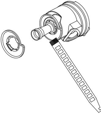
4. Zum leichteren Entfernen von Haaren, verwenden Sie den mitgelieferten Kupferdrahtpinsel.
