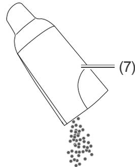
3. Leeren Sie den Staubbehälter (7) im Freien über einer Mülltonne aus.
