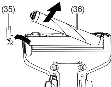
2. Nehmen Sie die Bürstenwalze (36) heraus und reinigen Sie sie mit einer Bürste.
