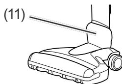
Die Universal-Bodendüse (11) ist fest mit dem unteren Geräteteil (9) verbunden. Diese Düse werden Sie beim Staubsaugen hauptsächlich benutzen. Sie ist geeignet für alle nieder- und mittelflorigen Teppichböden sowie für glatte Fußböden.
