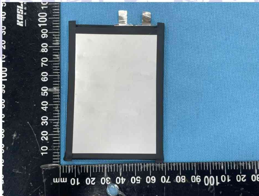
Photo 4 Internal Cell 内部电芯
