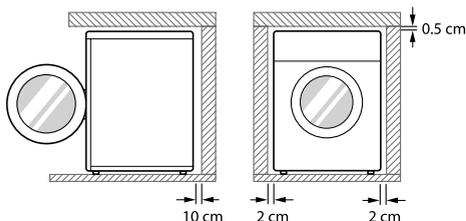
**Ebener Boden** : Das zulässige Gesamtgefälle unter dem Haushaltsgerät beträgt 1°.
