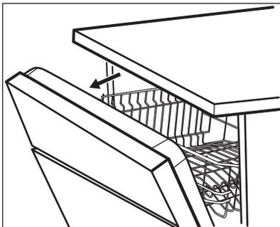
AirDry wird automatisch bei allen Programmen eingeschaltet außer bei (falls zutreffend).
