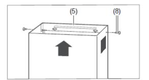
Ziehen Sie den oberen Teil der Kaminblende zur oberen Wandhalterung (5) herauf und schrauben Sie die Kaminblende mit zwei Schrauben (8) dort fest.
