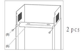
Schrauben Sie das Halteblech (6) mit zwei Schrauben (8) an den unteren Teil der Kaminblende.
