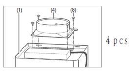
Schrauben Sie die Rückschlagklappe (4) oben auf der Dunstabzugshaube (1) mit 4 Schrauben (8) fest.
