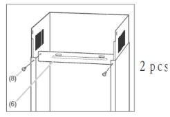
Schrauben Sie das Halteblech (6) mit zwei Schrauben (8) an den unteren Teil der Kaminblende.
