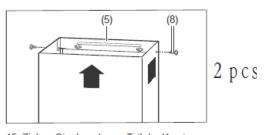
Ziehen Sie den oberen Teil der Kaminblende zur oberen Wandhalterung (5) herauf und schrauben Sie die Kaminblende mit zwei Schrauben (8) dort fest.
