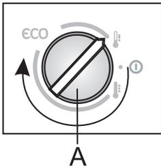
Falls die Temperatur der Umgebung, in welcher das Gerät aufgestellt ist, niedriger ist als 16°C, empfehlen wir, den Thermostatknobel **A** auf den
