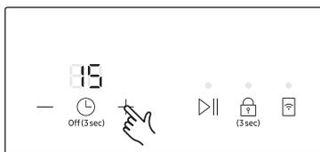
3. Verwenden Sie die Taste **Timer-Einstellung** ( oder ) , um die gewünschte Zeit einzustellen, nach der sich die Kochzone automatisch abschalten soll. Dies können zum Beispiel 15 Minuten sein. Die Abschaltung ist nun aktiviert. Der Timer kann in einem Bereich von 1 bis 99 eingestellt werden.
