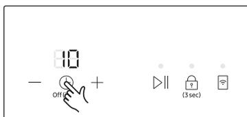
2. Berühren Sie die Taste . Über der Timer-Anzeige wird die Zahl 10 angezeigt. Die Standardeinstellung des Timers ist 10; das sind 10 Minuten.
