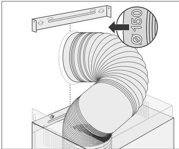
7. Nur bei Abluftbetrieb: Stecken Sie den Abluftschlauch (4) in den Anschluss des Wanddurchbruchs (Schlauchende mit 150 mm Durchmesser).
