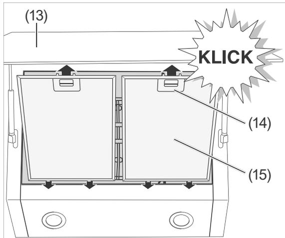
6. Setzen Sie die Fettfilter (15) mit den Zapfen in die Aussparungen.
