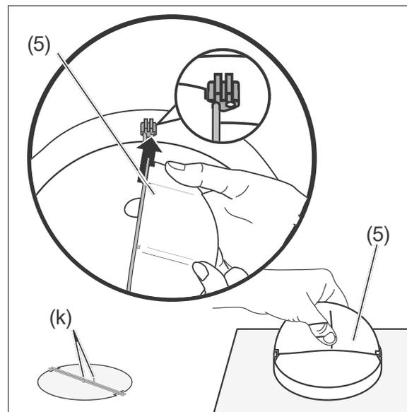
5. Setzen Sie die beiden Hälften der Rückschlagklappe (5) in die Öffnung oben auf die Dunstabzugshaube (1). Achten Sie darauf, dass die Stifte (k) außen auf den Klappen liegen.
