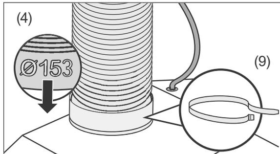
1. Stecken Sie das Ende des Abluftschlauches (4) mit dem größeren Durchmesser (153 mm) auf den Anschluss mit der Rückschlagklappe.
