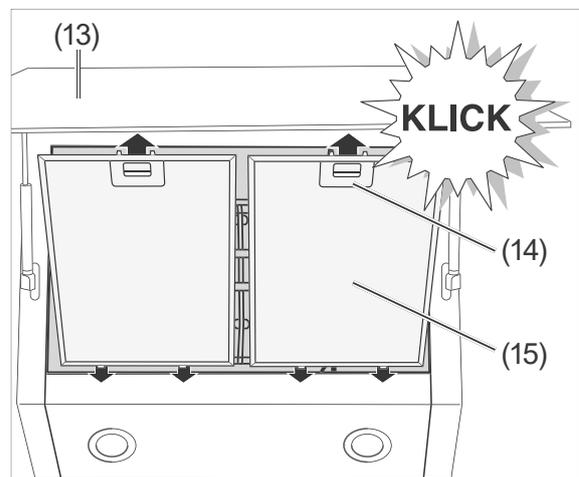
12. Setzen Sie die Fettfilter (15) mit den Zapfen in die Aussparungen.
