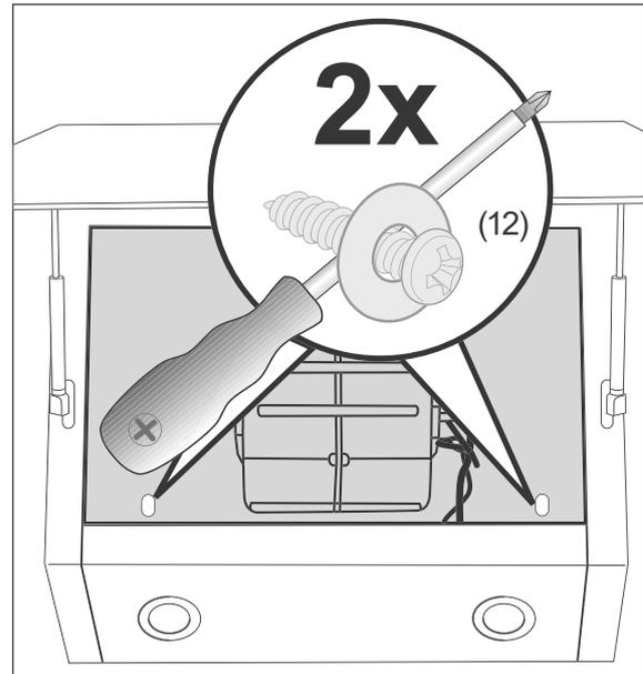
11. Drehen Sie zwei Rundkopfschrauben (12) zum Sichern der Dunstabzugshaube in die vorbereiteten Dübel, und schrauben Sie die Dunstabzugshaube an der Wand fest.
