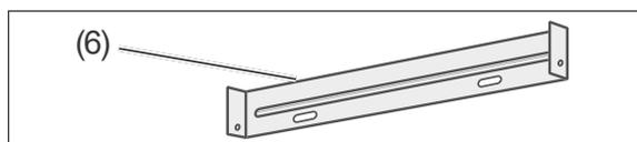
1. Schrauben Sie die Wandhalterung für die obere Kaminblende (6) mit 2 Rundkopfschrauben (10) in die vorbereiteten Dübel.
