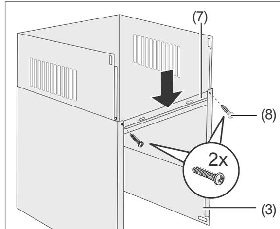
3. Positionieren Sie das Halteblech (7) so an der unteren Kaminblende (3), dass es von innen an den Abkantungen anliegt. (Schrauben- und Langlöcher zeigen nach oben).
