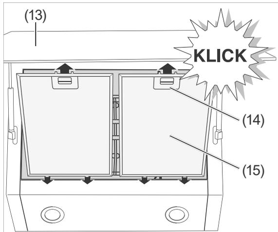
5. Setzen Sie die Fettfilter (15) mit den Zapfen in die Aussparungen.
