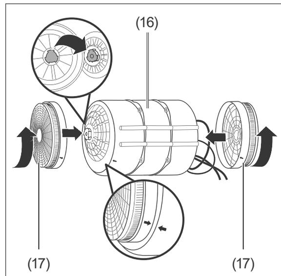
5. Setzen Sie die neuen Aktivkohlefilter rechts und links auf den Motor und drehen Sie sie gegen den Uhrzeigersinn fest. Dabei die Verriegelungen einrasten lassen.
