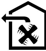
L'aria aspirata viene purificata attraverso il filtro per grassi e convogliata all'esterno tramite un sistema di tubi.
