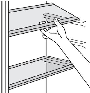
An den Seitenwänden im Geräteinneren sind mehrere Führungen angebracht, die eine beliebige Aufstellung der Ablagen ermöglichen.
