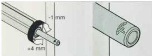
Eine Markierung am Ausstoßer gibt die Drehrichtung an. Bei einer Umdrehung (= 4 Rastpositionen) wird der Türspalt um 1 mm verstellt.
