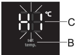
Bei überhöhter Temperatur im Geräteinneren wird ein unterbrochenes akustisches Signal ausgelöst und **HI** wird auf der Anzeigeeinheit blinken.
