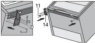
Befestigen Sie das Scharnier (14) mit den Schrauben auf der gegenüberliegenden Seite. Die Schrauben sollten in der in der Abbildung unten gezeigten Reihenfolge angebracht werden. Zuerst Schraube 1 festziehen, dann Schrauben 2. Dann die Stellfüße (11) anschrauben.
