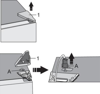
Entfernen Sie die obere Scharnierabdeckung (1). Seien Sie vorsichtig, damit Sie den Steckverbinder (A) nicht beschädigen. Steckverbinder (A) abziehen.
