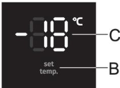
Verwenden Sie die **B**-Taste, um die Temperatur im Gerät einzustellen.
