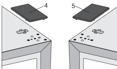
Nehmen Sie die (rechte) Abdeckung (4) aus dem Beutel und platzieren Sie sie an der Stelle, von der das obere Scharnier entfernt wurde. Entfernen Sie die Abdeckung von der anderen Seite (5), auf die das Scharnier gesteckt werden soll, und bewahren Sie sie auf.
