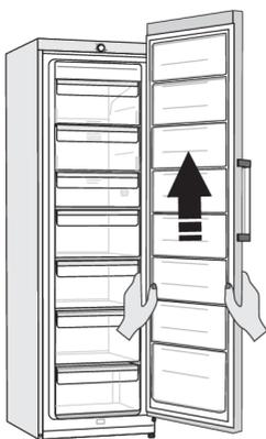
Entfernen Sie die Tür vom unteren Scharnier, indem Sie die Tür vorsichtig gerade nach oben heben. Legen Sie die Tür auf eine glatte Oberfläche.
