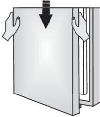
Positionieren Sie die obere Tür richtig, führen Sie den Verbinder (A) durch das Loch im oberen Scharnier (3) und verwenden Sie die Schrauben, (2) um sie anzubringen. Halten Sie die Tür fest, während Sie sie in Position bringen. Schließen Sie den Verbinder an (A).
