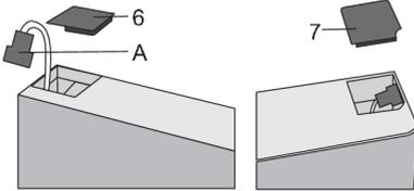
Entfernen Sie den Deckel (6) von der linken Seite der Tür und nehmen Sie den Verbinder (A) aus dem Raum unter dem Deckel. Entfernen Sie dann den Deckel (7) von der rechten Seite der Tür. Setzen Sie den Deckel (7) auf der linken Seite der Tür und den Deckel (6) auf der rechten Seite der Tür auf.
