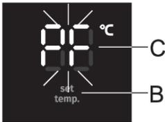
Wenn die Temperatur im Gerät während eines Stromausfalls (Stromversorgungsausfall) auf einen Alarmwert gestiegen ist, wird der Stromausfallalarm aktiviert, wenn die Stromversorgung wiederhergestellt ist. Ein akustischer Alarm ertönt und **PF** blinkt auf der Anzeigeeinheit **C** angezeigt.
