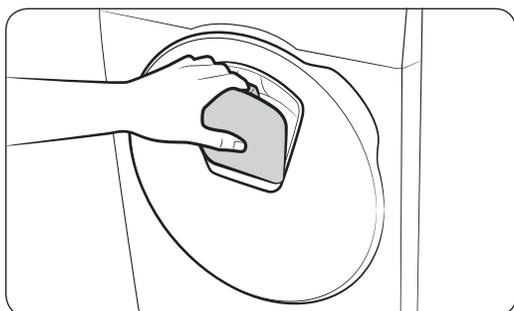
3. Öffnen Sie die AddWash-Tür vollständig und geben Sie dann durch die AddWash-Tür zusätzliche Wäsche in die Trommel.
