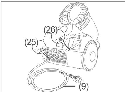
1. Ziehen Sie das Netzkabel (9) heraus, bis die gelbe Markierung (25) auf dem Netzkabel (9) sichtbar wird. Wenn die rote Markierung (26) zum Vorschein kommt, ist das Netzkabel (9) zu weit abgewickelt. Ziehen Sie das Netzkabel (9) etwas ein (siehe „Saugen beenden“ auf Seite 17).
