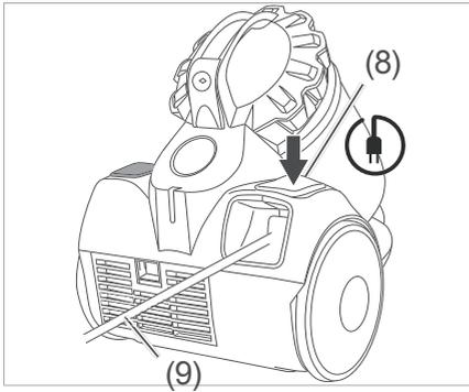
3. Treten Sie zum Aufwickeln des Netzkabels (9) auf den Fußschalter für Kabelaufwicklung (8). Halten Sie dabei das Netzkabel (9) am Netzstecker in der Hand, um einen eventuellen „Peitscheneffekt“ zu verhindern.
