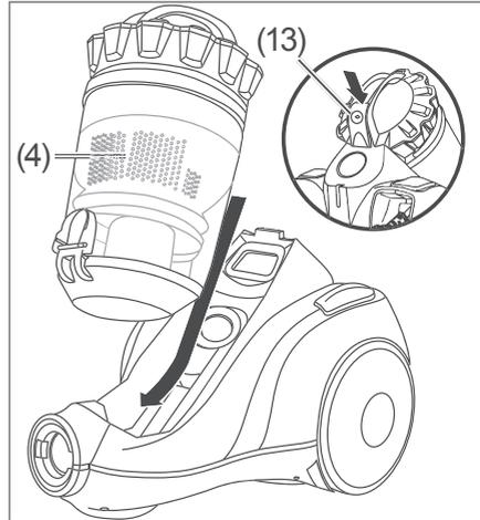
7. Setzen Sie den Staubbehälter (4) so wieder in den Staubsauger ein, dass die Verriegelungstaste (13) hörbar einrastet.
