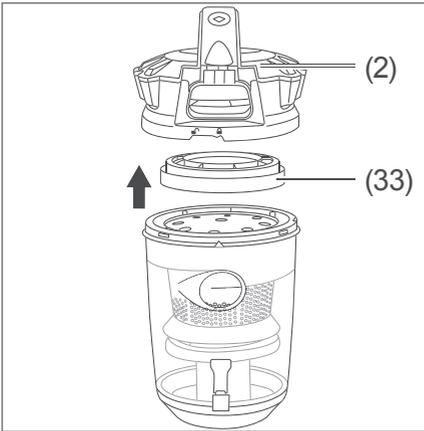
4. Heben Sie den Staubbehälterdeckel (2) ab.
