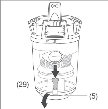
4. Schieben Sie die Verriegelung (29) nach unten. Der Staubbehälterboden (5) klappt nach unten.
