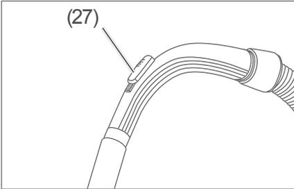
Bei Bedarf können Sie die Saugkraft mithilfe des Nebenluftventils (27) regulieren. Die Abdeckung des Nebenluftventils (27) lässt sich stufenlos verschieben.
