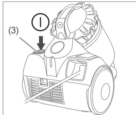
1. Treten Sie mit dem Fuß auf den Fußschalter Ein/Aus (3), um das Gerät auszuschalten.
