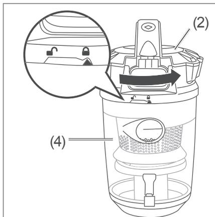
3. Halten Sie den Staubbehälterdeckel (2) und Staubbehälter (4) jeweils mit einer Hand fest. Drehen Sie dann den Staubbehälterdeckel (2) gegen den Uhrzeigersinn, bis die Markierung ▲ am Staubbehälter (4) auf das Symbol ■ zeigt.
