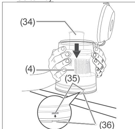
10. Stellen Sie den Grobstaubfilter (34) mit dem Kopf nach unten auf die Arbeitsplatte.
