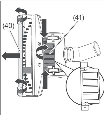
2. Öffnen Sie die Wartungsklappe (40) auf der Unterseite der Turbobürste.
