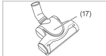
Die rotierende Turbobürste (17) wird durch den Saug-Luftstrom angetrieben. Sie eignet sich besonders für Verschmutzungen wie z. B. Haare und Fäden auf Teppichen und Teppichböden.
