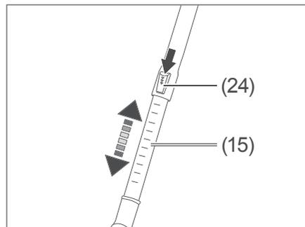
6. Um die Länge des Teleskoprohres (15) zu verändern und dadurch an die Körpergröße des Benutzers anzupassen, drücken Sie den Arretierknopf (24) nach unten, und schieben Sie dabei das Teleskoprohr (15) auseinander oder zusammen.
