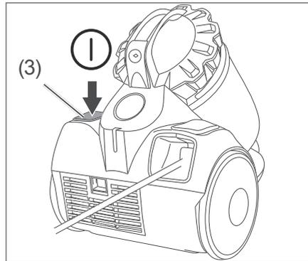
3. Treten Sie mit dem Fuß auf den Fußschalter Ein/Aus (3), um das Gerät einzuschalten.
