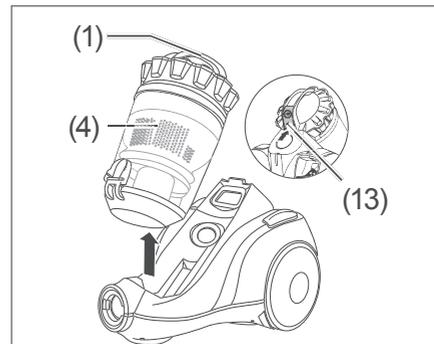
2. Drücken Sie die Verriegelungstaste (13) für den Staubbehälter, und heben Sie den Staubbehälter (4) am Tragegriff (1) nach oben aus dem Gerät heraus.
