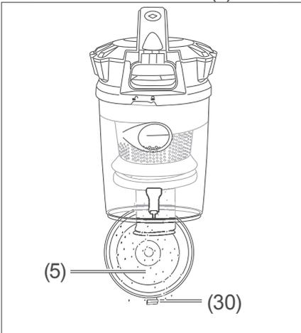
6. Klappen Sie den Staubbehälterboden (5) zurück, so dass
