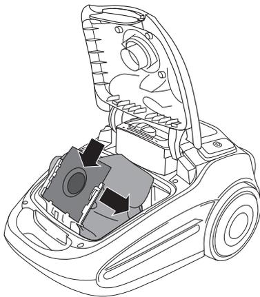
5. Schieben Sie einen neuen Staubbeutel in den Staubbeutelhalter (28).
