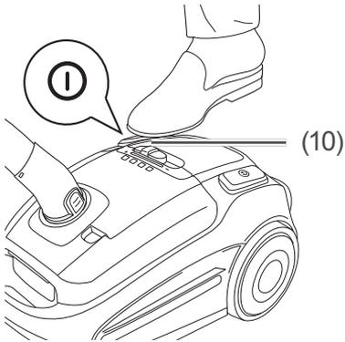
1. Treten Sie mit dem Fuß auf den Fußschalter Ein / Aus (10), um das Gerät auszuschalten.
