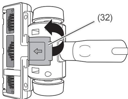
2. Öffnen Sie die Wartungsklappe (32) auf der Unterseite der Turbobürste.
