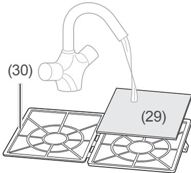
5. Klappen Sie den Rahmen auf, und waschen Sie den Motorschutz-Filter (29) unter fließendem Wasser aus. Wenn der Motorschutz-Filter (29) beschädigt sein sollte oder nicht mehr ausreichend gereinigt werden kann, muss er gegen einen neuen ausgetauscht werden.
