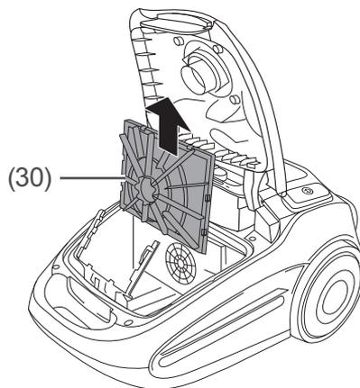
4. Drücken Sie den Griff am Rahmen (30) des Motorschutz-Filters nach unten und ziehen Sie ihn nach vorn. Nehmen Sie den Rahmen heraus.
