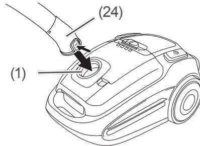
4. Auf der anderen Seite des Saugschlauchs befinden sich am Verbindungsstück (24) zwei Federn. Drücken Sie beide Federn leicht zusammen, während Sie das Verbindungsstück in die Öffnung (1) stecken.
