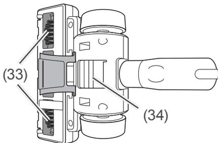
3. Entfernen Sie Fusseln und Haare von der Bürste (33) und vom Luftschaufelrad (34).
