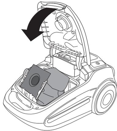
7. Verschließen Sie wieder das Staubbeutel Fach (6). Achten Sie dabei darauf, dass der Staubbeutel nirgends eingeklemmt wird.
