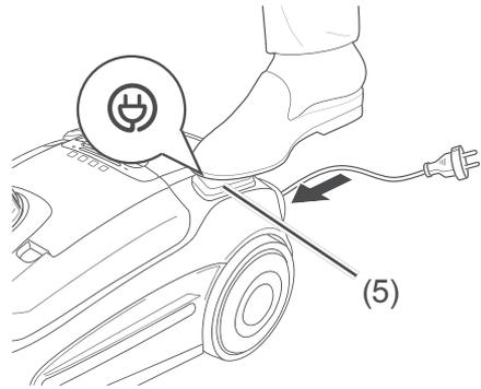
3. Treten Sie zum Aufwickeln des Netzkabels auf den Fußschalter für Kabelaufwicklung (5). Halten Sie dabei das Netzkabel in der Hand, um einen eventuellen „Peitschenschlag“ zu verhindern.
