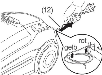
1. Ziehen Sie das Netzkabel (12), bis die gelbe Markierung auf dem Netzkabel sichtbar wird, heraus.
