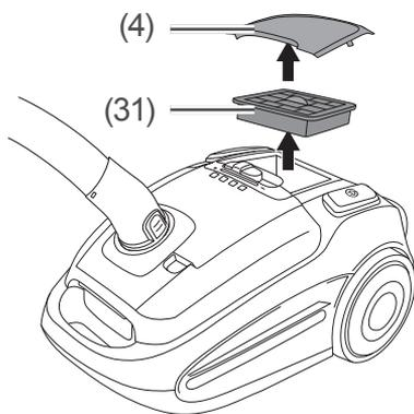
2. Drücken Sie die Filterabdeckung (4) an den beiden Vorsprüngen nach oben und nehmen Sie sie ab.
