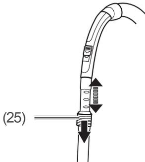
6. Die Länge des Teleskoprohrs (16) lässt sich verändern und dadurch an die Körpergröße des Benutzers anpassen. Drücken Sie hierfür die Halterung (25) nach unten und schieben Sie dabei das Teleskoprohr (16) auseinander- oder zusammen. Mit einem Klick rastet das Teleskoprohr in der nächsten Kerbe ein.
