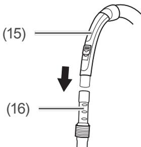
3. Stecken Sie den Saugschlauch (15) und das Teleskoprohr (16) zusammen.
