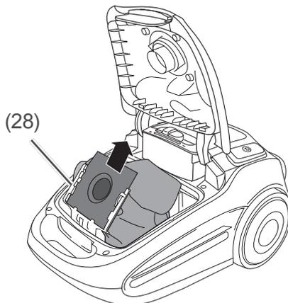
3. Ziehen Sie den Staubbeutel an der Pappflasche nach oben aus dem Staubbeutelhalter (28) heraus. Der Staubbeutelhalter klappt dabei in eine senkrechte Position.
