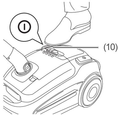
3. Treten Sie mit dem Fuß auf den Fußschalter Ein / Aus (10), um das Gerät einzuschalten.
