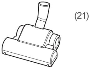
Die rotierende Turbobürste wird durch den Saug-Luftstrom angetrieben. Sie eignet sich besonders für hartnäckige Verschmutzungen auf Teppichen und Teppichböden. Deshalb beim Einsatz der Turbobürste (21) den Staubsauger auf maximale Saugleistung einstellen (siehe Abschnitt „Saugkraft einstellen“ auf Seite 17).
