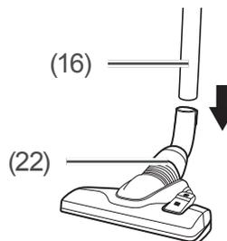
5. Wählen Sie die gewünschte Saugdüse aus, z. B. die Bodendüse (22), und stecken Sie sie auf das Teleskoprohr. Sie können alle Düsen auch auf den Teleskoprohrgriff am Saugschlauch (15) stecken.
