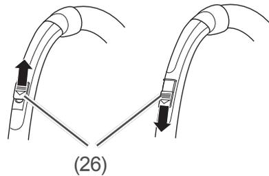
Bei Bedarf können Sie die Saugkraft mithilfe des Nebenluftventils (26) weiter verringern. Die Abdeckung des Nebenluftventils lässt sich stufenlos verschieben.
