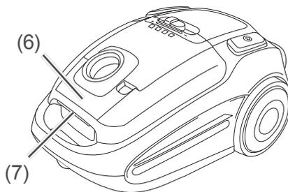
2. Öffnen Sie den Deckel des Staubbeutel-fachs (6) am Entriegelungsgriff (7) und schwenken Sie ihn nach oben.
