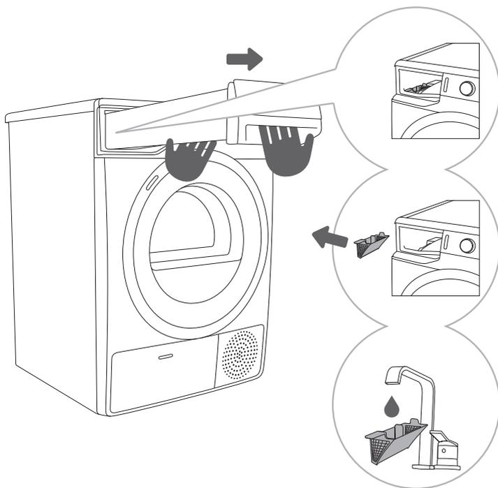
**1** Ziehen Sie den Kondenswasserbehälter heraus (mit beiden Händen wie auf der Abbildung dargestellt).
