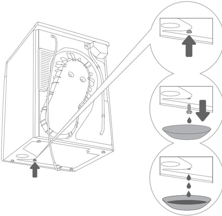
**1** Der Stopfen zum Entleeren des Dampfgeneratorbehälters befindet sich unten (siehe Abbildung).
