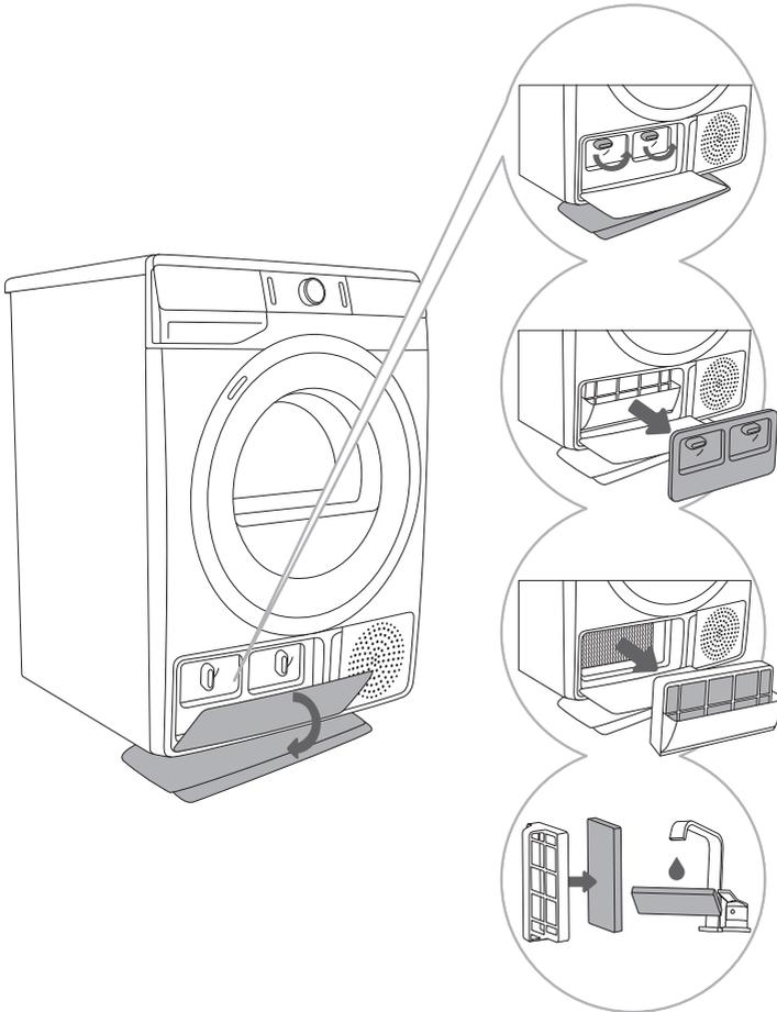
**1** Öffnen Sie den Außendeckel. Fassen Sie die Griffe am Innendeckel an und drehen Sie sie nach oben. Nehmen Sie den Innendeckel ab.
