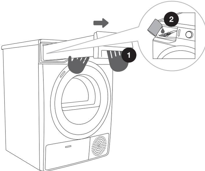
**1** Ziehen Sie den Dampfgeneratorbehälter heraus (mit beiden Händen wie auf der Abbildung).
