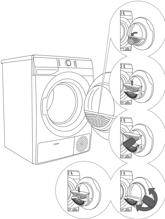
**1** Öffnen Sie das Filtergehäuse.
