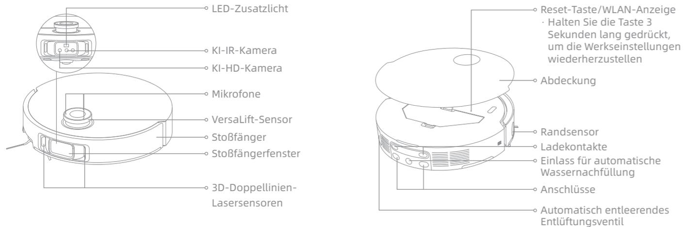
Hinweis: Der VersaLift-Sensor wird abgesenkt, wenn sich der Roboter im Standby-Modus befindet, an der Basisstation lädt oder Bereiche mit geringem Abstand reinigt. Bewegen Sie den Roboter beim Reinigen von Bereichen mit geringem Abstand nicht, da dies seine Positionierung beeinträchtigen könnte.
