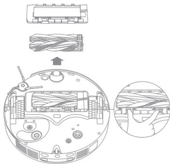
2. Ziehen Sie die Bürsten wie in der Abbildung gezeigt heraus. Entfernen Sie mit dem geeigneten Reinigungswerkzeug alle in der Bürste verhedderten Haare. Drücken Sie die Bürsten nach der Reinigung fest in den Hauptbürstenhalter, bis sie einrasten.
