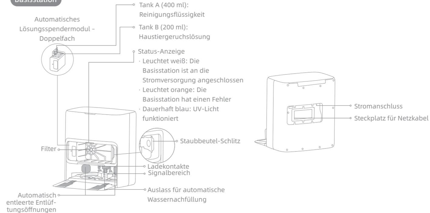
Hinweis: Das Doppelfach kann durch ein Einzelfach ersetzt werden, um mehr Reinigungslösung hinzuzufügen. Bei Bedarf bitte separat erwerben.
