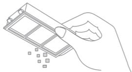
Hinweis: Reinigen Sie den Filter niemals mit einer Bürste, einem Finger oder scharfen Gegenständen, um Schäden zu vermeiden.
