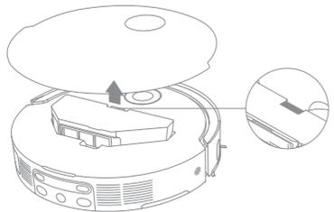
2. Entfernen Sie den Staubbehälterfilter und leeren Sie anschließend den Staubbehälter.
