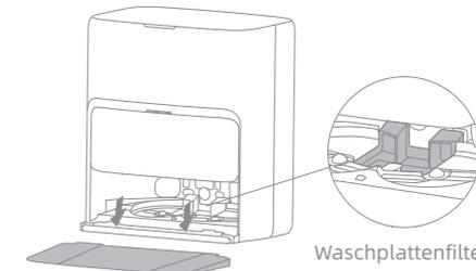
Hinweis: Stellen Sie sicher, dass der Waschplattenfilter richtig eingesetzt ist.
