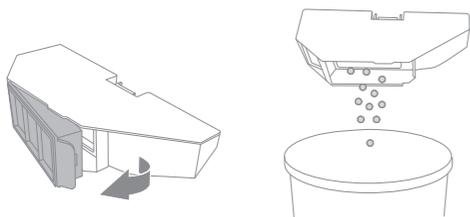
3. Klopfen Sie leicht auf den Korb des Filters, um den Schmutz zu entfernen.
