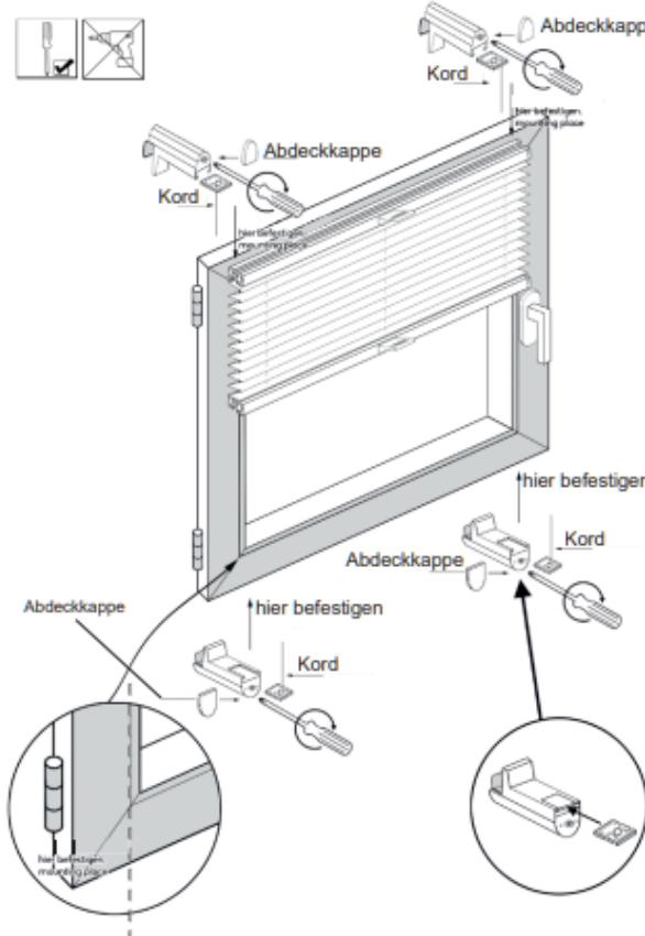
Die Klemmträger werden oben und unten am geöffneten Fensterflügel angebracht.
