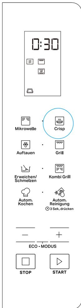
Mit dieser exklusiven Bauknecht-Funktion erzielen Sie eine perfekte Bräunung der Ober- und Unterseite von Lebensmitteln. Durch gleichzeitige Verwendung von Mikrowelle und Grill erreicht die Crisp-Platte schnell die richtige Temperatur, wodurch jedes Lebensmittel seine spezielle Bräunung und Knusprigkeit erreicht.
