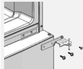
6. Gerätetür vorsichtig aus dem unteren Scharnier aushebeln.
