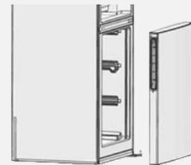
7. Unteres Scharnier und den verstellbaren Fuß lösen.
