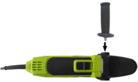
Afb. 11: Extra handgreep monteren
