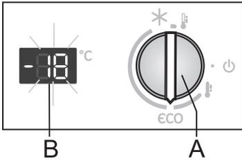
Bei zu hoher Temperatur im Geräteinneren ertönt ein akustischer Alarm. Auf dem Display wird die Solltemperatur angezeigt und ein LED-Indikatorlämpchen blinkt, falls es eingebaut ist.
