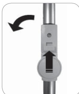
3. U kunt de steel in een hoek van 90° buigen om het apparaat beter te kunnen bedienen: Druk de knop aan de zijkant van het scharnier in en beweeg de steel in de richting van het accuvak (zie afbeelding). De hoek kan traploos worden veranderd.
