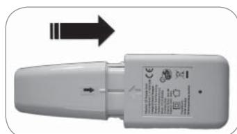
1. Steek de accu in de oplader. De accu moet hoorbaar in de oplader vastklikken. De accu past slechts in één richting in de oplader (pijl op pijl; zie afbeelding).
