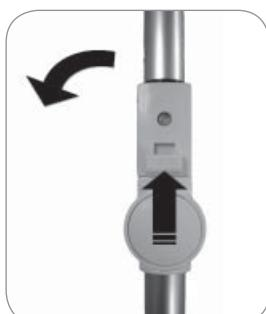
3. Pour faciliter la manipulation, vous pouvez incliner la barre jusqu'à 90 degrés : Appuyez sur la touche située sur le côté du système d'articulation et déplacez la barre en direction du compartiment de batterie (voir illustration). L'angle est réglable en continu.
