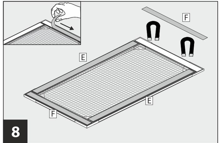
**8** Metallband für die Höhe **E** und für die Breite **F** auf die bereits eingedrückten Magnet-Klemmleisten auflegen, ausrichten und die Schutzfolie abziehen.
