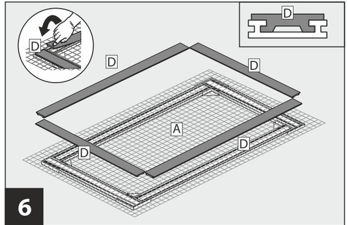
**6** Insektenschutzgewebe **A** mit den bereits auf Maß geschnittenen Magnet-Klemmleisten **D** befestigen. Dazu die Magnet-Klemmleisten **D** in den Profilkanal eindrücken, **nicht einschlagen. Beschädigungsgefahr.** Verwenden Sie ggf. den Stiel eines Hammers als Druckhilfe, um die Magnet-Klemmleisten einzudrücken.
