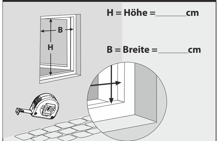
Messen Sie von Fensterrahmen Innenkante zu Innenkante (lichtes Maß) und notieren sich das Ergebnis.
