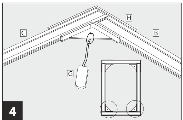
**Optional:** Zugkordel **G** an den unteren beiden Eckverbindern **H** befestigen.
