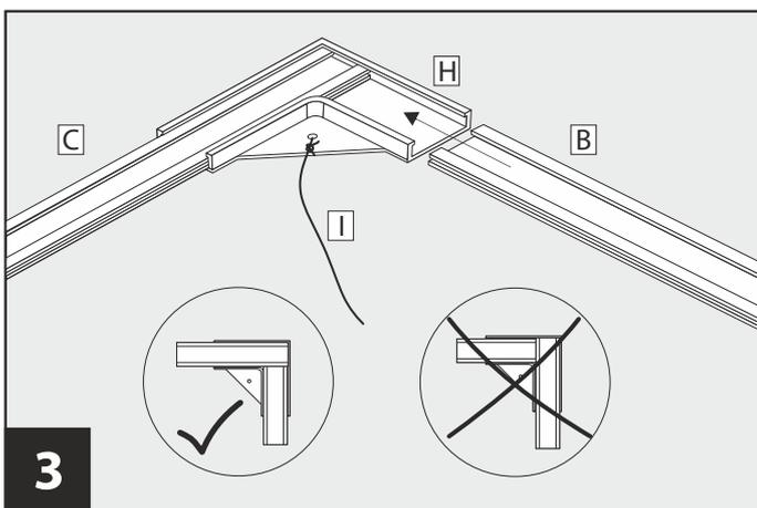
Rahmenprofil für die Höhe **B** und Rahmenprofil für die Breite **C** in die Eckverbinder **H** einschieben.
