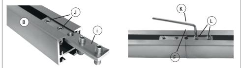
Möchten Sie einen Träger (siehe Schritt 2) genau bei der Profilstückelung setzen, kann der Nutstein © vom Träger (A) abgenommen werden (Nutstein wird nicht mehr benötigt). Nun befestigen Sie den Schrauben (D) und drehen Sie diesen in das mittlere Loch (E) des Profilverbinders (i).
