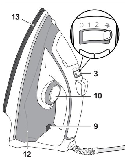
1. Wassertank 12 vollständig füllen.
