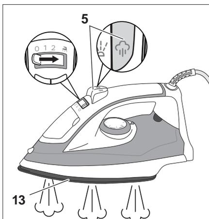
4. Benutzen Sie die Dampfstoßfunktion nur so lange, bis der Wassertank leer ist und kein Dampf mehr produziert wird.
