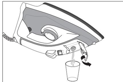
1. Entleeren Sie das Dampfbügeleisen, wie in der Abbildung dargestellt.
