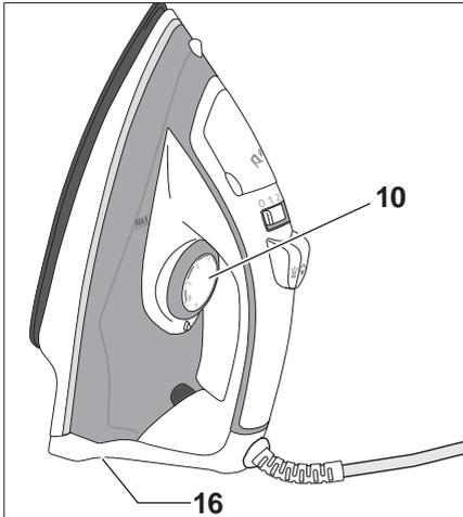
1. Temperaturregler **10** auf „O“ drehen (im Uhrzeigersinn)
