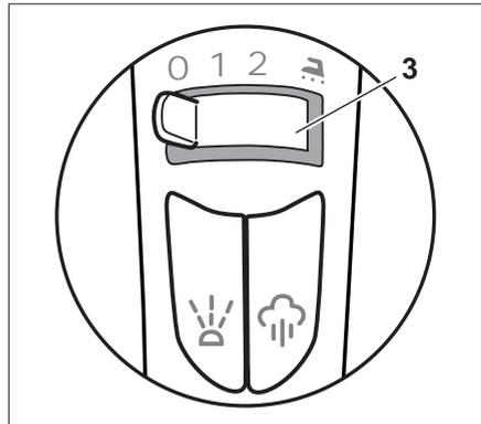
Beim Trockenbügeln stellen Sie den Dampfreger **3** in Position **0**, und wählen Sie dann die gewünschte Bügeltemperatur, wie im Abschnitt „Temperatur einstellen“ beschrieben.
