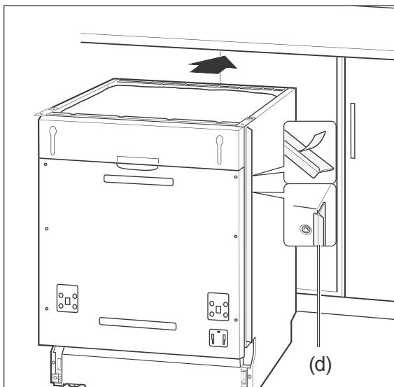
4. Entfernen Sie die Schutzfolien von den seitlichen Abschlussprofilen (d).
