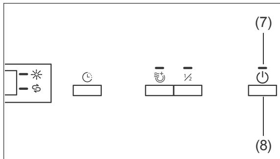
1. Öffnen Sie die Gerätetür und schalten Sie den Geschirrspüler mit der Taste  $\odot$  (8) ein. Die Anzeige (7) leuchtet.
