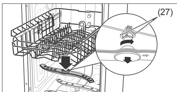
3. Der obere Sprüharm ist mit einem Bajonettschluss befestigt. Zum Abnehmen des Sprüharms halten Sie die beiden gezackten Bajonetegriffe (27) fest und drehen Sie den Sprüharm im Uhrzeigersinn ab.
