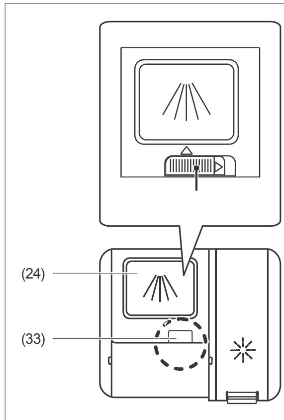
1. Schieben Sie den Verschluss (33) der Spülmittelkammer (24) zur Seite. Der Deckel springt auf.
