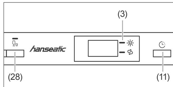
2. Drücken Sie innerhalb von 60 Sekunden nach dem Einschalten 5 Sekunden lang die Programmtaste  $\square$  (28).
