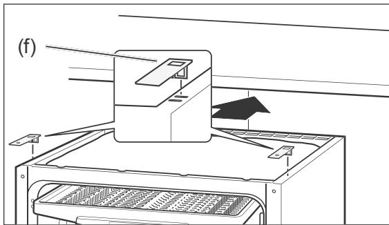
3. Stecken Sie beide Montagewinkel (f) in die vorderen Schlitze an der oberen Seite des Geschirrspülers, um später den Geschirrspüler an die Arbeitsplatte anzuschrauben zu können.
