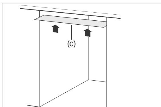
Kleben Sie die beiliegende Schutzfolie für Kondenswasser (c) auf die Unterseite der Arbeitsplatte. So vermeiden Sie Schäden an der Arbeitsplatte aufgrund heißer Dämpfe, die bei geöffneter Tür aus dem Geschirrspüler strömen.
