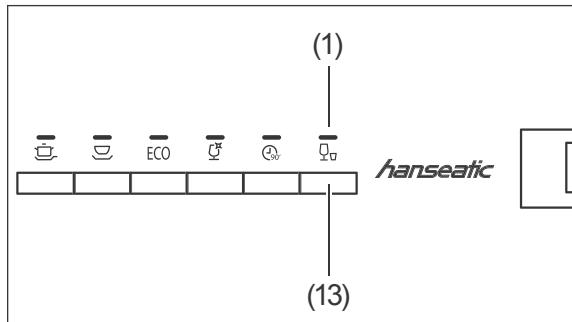
2. Halten Sie die Taste  $\square$  (13) so lange gedrückt, bis das Display den aktuellen Härtegrad anzeigt ( $H\ddot{I}$  bis  $H\ddot{E}$ ).
