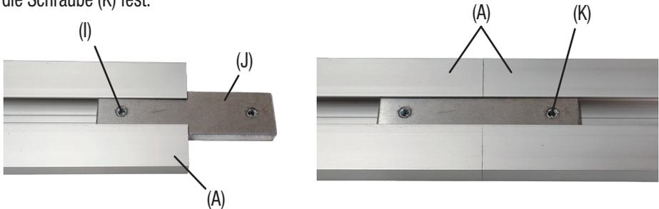
**Achtung:** Verbinden Sie zuerst die Profile mit den Profilverbindern und setzen Sie erst danach mit der weiteren Montage fort.
