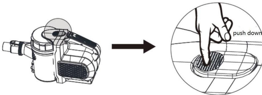
Abbildung 4 Verriegelung Behälter
