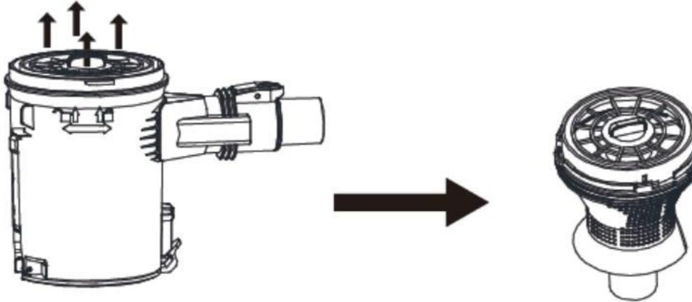
Abbildung 7 Filtereinheit lösen
