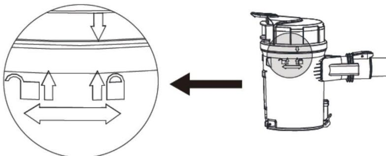
Abbildung 6 Staubbeutelbehälter lösen
