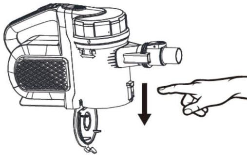
Abbildung 3 Staubbehälter leeren
