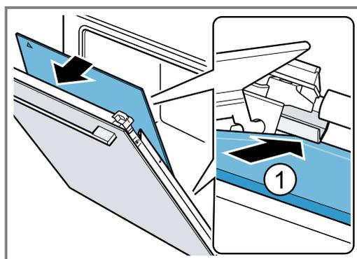
2. **Hinweis:** die Zwischenscheibe positioniert sich automatisch durch die Drehbewegung der Abstandhalterung.
