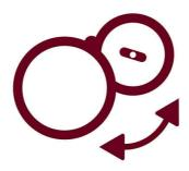
Der Filterhalter wird geöffnet, indem Sie ihn zur Seite aufschwingen, was das Auffüllen des Kaffees ganz einfach macht. Der Filterhalter kann zur einfachen Reinigung abgenommen werden.
