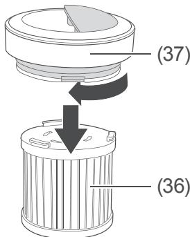
6. Setzen Sie die Filterabdeckung (37) wieder auf den Hygiene-Filter (36) auf, und drehen Sie sie **im Uhrzeigersinn** fest.
