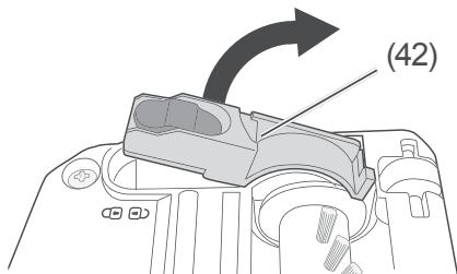
3. Entfernen Sie den Verschlussriegel (42).
