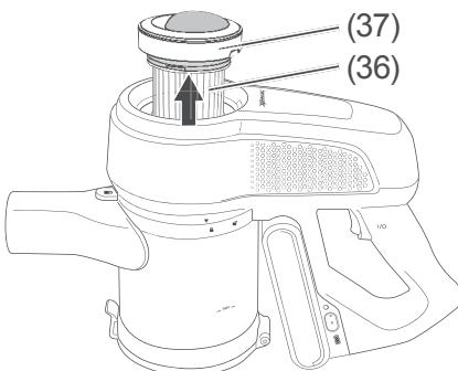
2. Heben Sie den Hygiene-Filter (36) an der Filterabdeckung (37) heraus.
