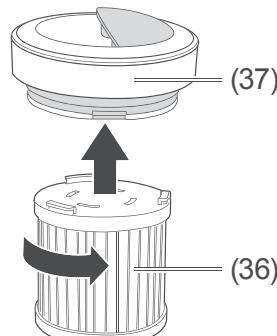
3. Drehen Sie die Filterabdeckung (37) **gegen den Uhrzeigersinn**, und nehmen Sie sie vom Hygiene-Filter (36) ab.
