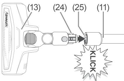
3. Wählen Sie die gewünschte Düse aus, z. B. die Bodendüse (13), und stecken Sie den Stecker (24) der Bodendüse (13) in die Öffnung (25) an der Rohrverlängerung (11).
