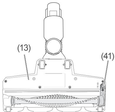
2. Schieben Sie den Schieber (41) an der Unterseite der Bodendüse (13) in die „Offen“-Position (in Richtung des Symbols
