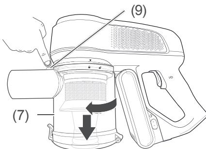
2. Drücken Sie die Entriegelungstaste (9) für den Staubbehälter (7).
