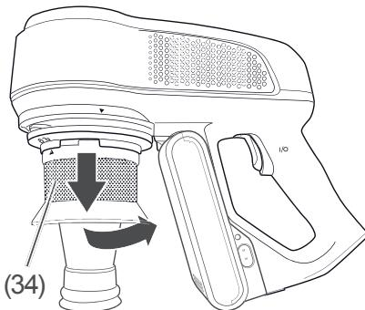
4. Drehen Sie den Staubfilter (34) gegen Uhrzeigersinn, bis das Symbol
