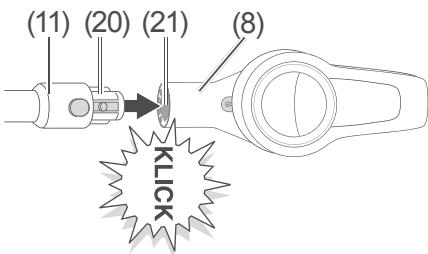
2. Stecken Sie den Stecker (20) an der Rohrverlängerung (11) in die Öffnung (21) am Saugrohr (8).
