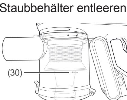
Spätestens wenn der Staub im Staubbehälter die Markierung "Full" (30) erreicht, sollten Sie den Staubbehälter entleeren.
