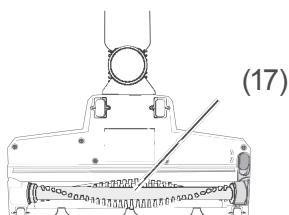
Die rotierende Bürste (17) wird durch den Saug-Luftstrom ange-
