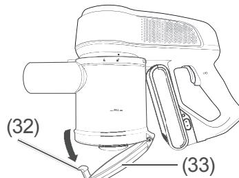
3. Drücken Sie die Verriegelungstaste (32) am Staubbehälterboden (33). Der Staubbehälterboden (33) klappt nach unten, und der Staub fällt in den Mülleimer.
