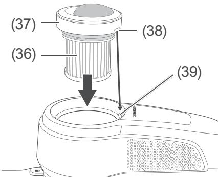
7. Setzen Sie den Hygiene-Filter (36) mit Filterabdeckung (37) wieder ein. Achten Sie dabei darauf, dass die Aussparung (38) in der Filterabdeckung (37) in den Vorsprung (39) am Gerätegehäuse eingreift.
