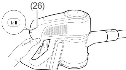
Das Gerät verfügt über zwei Saugkraftstufen. Die Saugkraft-stufe stellen Sie mit dem Saugkraftstufenschalter (26) ein.
