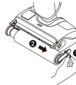
3. Entfernen Sie mit der mitgelieferten Reinigungsbürste alle auf der Bürstenrolle befindlichen Haare und Verschmutzungen. Spülen Sie die Bürstenrolle und die Abdeckung mit sauberem Wasser ab und trocknen Sie diese vollständig.
