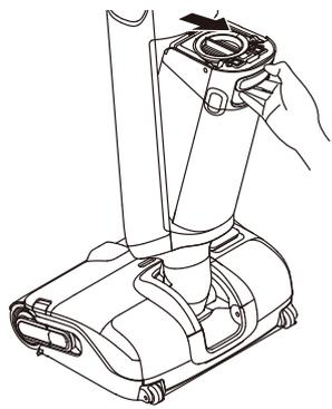
2. Ziehen Sie den Griff der Abdeckung des Schmutzwasserbehälters nach oben, heben Sie die Abdeckung an. Nehmen Sie den Filter heraus.
