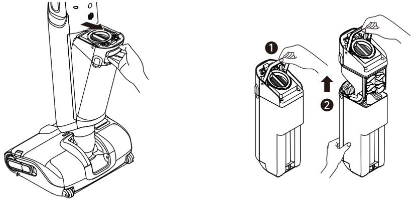
3. Gießen Sie das Schmutzwasser aus und entfernen Sie die festen Rückstände aus dem Schmutzfilterkorb.
