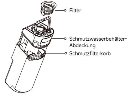
3. Gießen Sie das Schmutzwasser aus und entfernen Sie die festen Rückstände aus dem Schmutzfilterkorb. Spülen Sie mit sauberem Wasser nach. Reinigen Sie die Innenwände des Behälters mit der mitgelieferten Reinigungsbürste.
