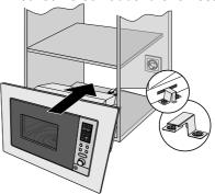
Schieben Sie das Gerät in das-Einbaufach, bis die Frontblende auf dem Rahmen des Einbaufachs auftrifft.
