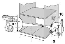
Bohren Sie die Löcher (Sie brauchen einen Bohrer der Größe 3 mm); legen Sie den Kippschutz erneut an, und schrauben Sie ihn mit zwei Schrauben 10 mit einem Kreuzschlitzschraubendreher fest.
