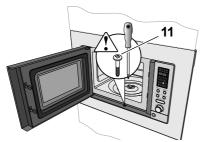
Sichern Sie das Gerät mit der mitgelieferten Schraube 11 gegen Herausrutschen.
