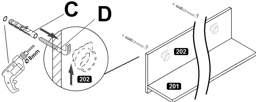
**D** Das beigegebue Wandbefestigungsmaterial (Dübel und Schrauben) eignet sich nur für festes Mauerwerk (z.B. Beton- oder Ziegelwände). Für andere Wandaufbauten sind eventuell Spezialdübel und andere Schrauben notwendig. Ziehen Sie gegebenenfalls eine Fachkraft zurate.
