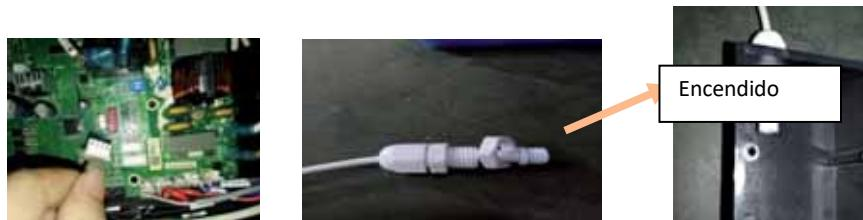
4. Vuelva a conectar el controlador y vuelva a colocar las cubiertas quitadas.
