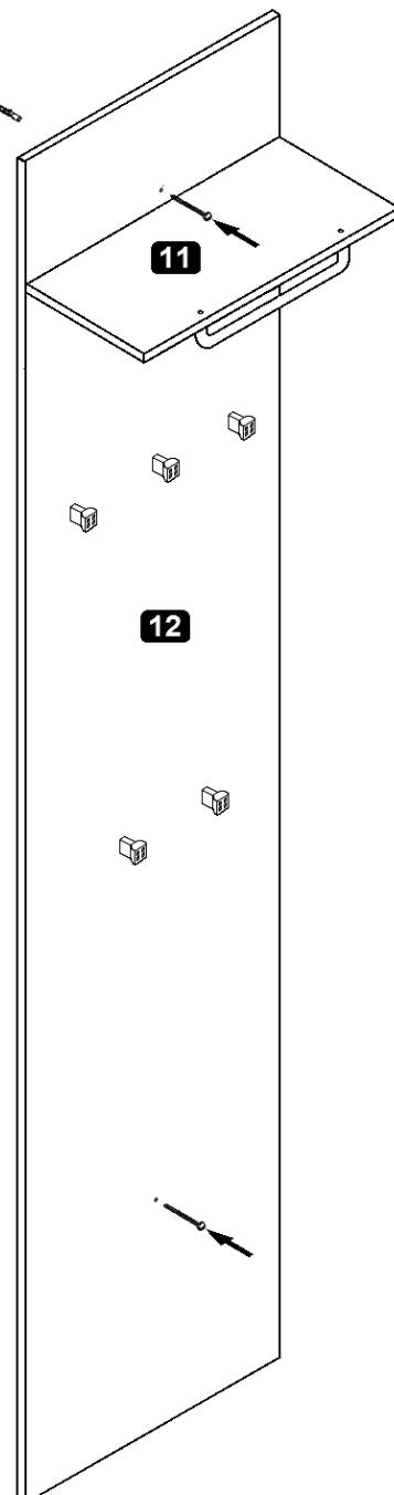
**D** Das beigegebogene Wandbefestigungsmaterial (Dübel und Schrauben) eignet sich nur für festes Mauerwerk (z.B. Beton- oder Ziegelwände). Für andere Wandaufbauten sind eventuell Spezialdübel und andere Schrauben notwendig. Ziehen Sie gegebenenfalls eine Fachkraft zurate.
