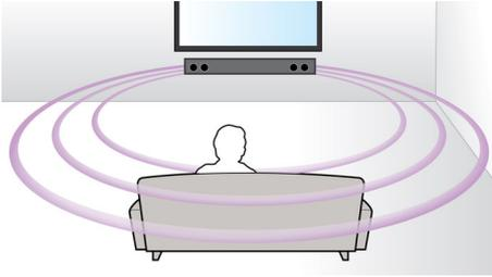
Philips Virtual Surround Sound liefert über weniger als fünf Lautsprecher einen satten und unvergesslichen Surround Sound. Hoch entwickelte Algorithmen bilden die Klangmerkmale originalgetreu nach, die in einer idealen 5.1-Kanal-Umgebung vorkommen. Jede hochwertige Stereoquelle kann in realistischen Mehrkanal-Surround Sound verwandelt werden. Sie benötigen keine zusätzlichen Lautsprecher, Kabel oder Lautsprecherständer, um ein raumfüllendes Klangerlebnis zu genießen.
