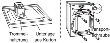
Transportschrauben und Trommelhalterung entfernen.
