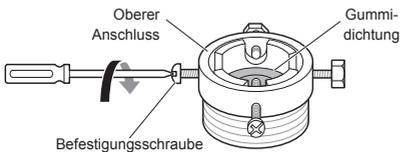
2 Nehmen Sie den Führungsring heraus, falls der Wasserhahn zu groß für den Adapter ist.
