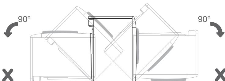
☀ Nach der Aufstellung das Gerät vor dem Gebrauch mindestens 24 Stunden ruhen lassen. Falls das Gerät beim Transport oder bei Wartungseingriffen auf den Boden gelegt werden muss, legen Sie es auf die linke Seite (von vorne betrachtet).
