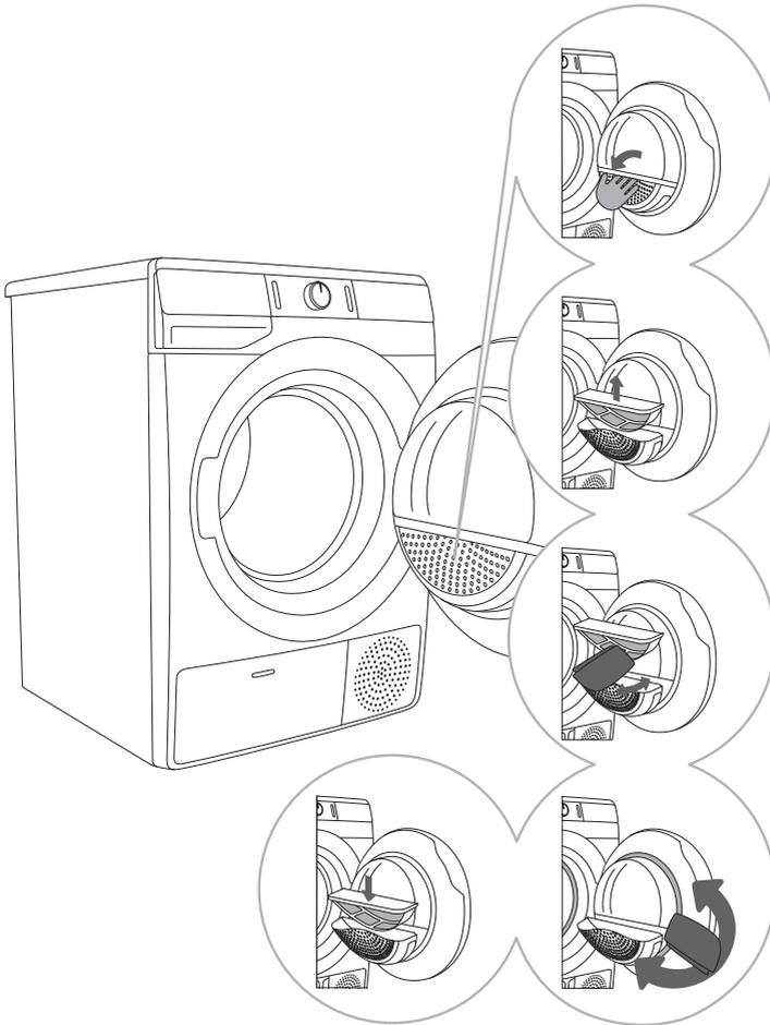
**1** Öffnen Sie das Filtergehäuse.
