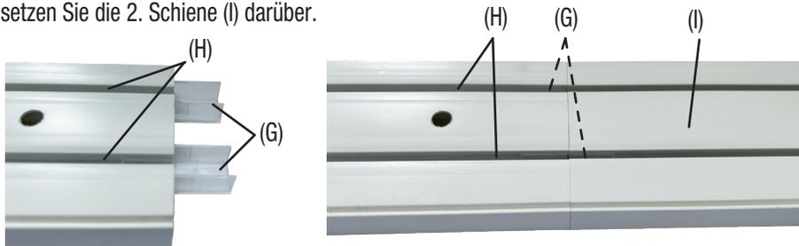
**Achtung: Verbinden Sie zuerst die Schienen mit den Schienenverbindern und setzen Sie erst danach mit der weiteren Montage fort.**
