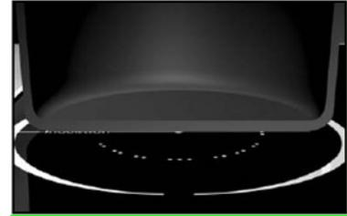
Im Gegensatz dazu erwärmt sich ein Induktionskochfeld nicht selbst, sondern erzeugt ein elektromagnetisches Wechselfeld (20-50 kHz). Dieses Magnetfeld erzeugt im Boden eines geeigneten Kochgeschirrs Teilchen Verwirbelungen, die zu einer Erwärmung führen.
