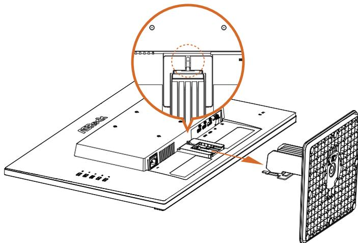
2. Ziehen Sie den Freigaberiegel mit Ihrem Finger, während Sie den Ständerarm gegen den Uhrzeigersinn in die Freigabeposition drehen. Entfernen Sie den Ständerarm von der Ständerbasis.
