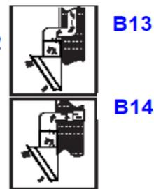
**4.** Die Haube an der Halterung **B3** aufhängen und Haube durch die 2 Löcher in der Rückwand **B15** festschrauben, damit die Haube nicht versehentlich aushängen kann.
