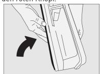
Setzen Sie die Filterschublade wieder ein, fixieren Sie die Filterschubladenabdeckung durch Drehen in Pfeilrichtung. Achten Sie darauf, dass die Abdeckung richtig sitzt.
