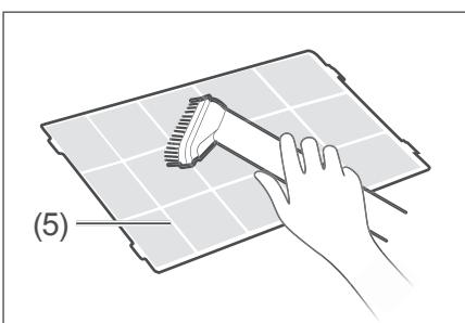
4. Reinigen Sie den Vorfilter (5) entweder mit einer Bürste, indem Sie seitwärts über den Filter fahren, oder mit dem Staubsauger.
