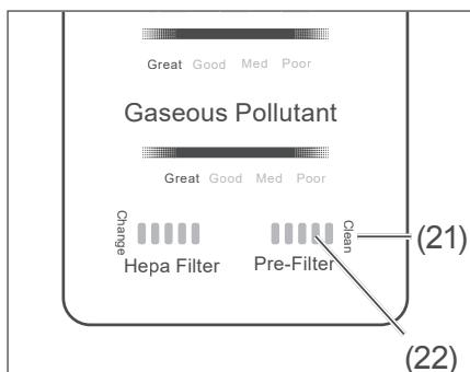
Im Laufe des Gebrauchs erlöschen nacheinander die Balken der Verschmutzungsanzeige (22) für den Vorfilter. Wenn der letzte Balken rot wird und die Anzeige „Clean“ (21) aufleuchtet, sollten Sie den Vorfilter reinigen.
