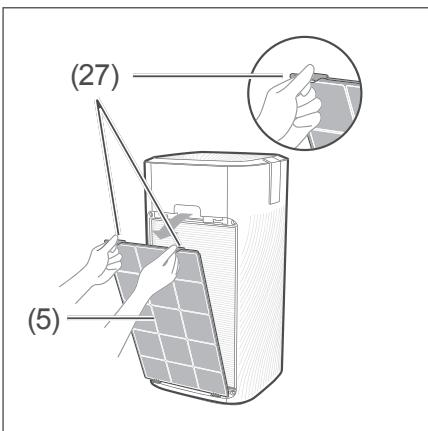
3. Entnehmen Sie den Vorfilter (5). Drücken Sie hierzu die Entriegelungstasten (27).
