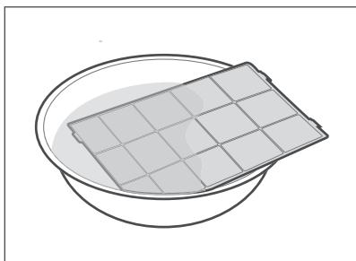
Sollte der Vorfilter (5) stark verschmutzt sein, können Sie ihn auch in herkömmlicher Spülmittellauge zehn Minuten lang einweichen und dann vorsichtig mit einer Bürste reinigen. Lassen Sie den Vorfilter danach **vollständig durchtrocknen**, bevor Sie ihn wieder einsetzen.
