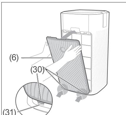
3. Setzen Sie die Filterabdeckungen (6) wieder ein. Achten Sie dabei darauf, dass die Zapfen (30) in die Aussparungen (31) eingreifen.
