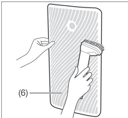
2. Reinigen Sie die Filterabdeckungen (6) entweder, indem Sie sie mit der Fugen- oder Möbeldüse eines Staubsaugers absaugen, oder mit einer weichen Bürste.
