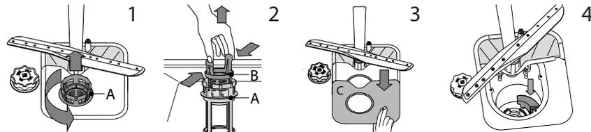
Falls Sie Fremdkörper (wie Glasscherben, Porzellan, Knochen, Fruchtsamen usw.) finden, **entfernen Sie diese bitte sorgfältig.** Das Spülpumpenschutzteil (schwarzes Teil) **NICHT ABGENOMMEN WERDEN** (Abb 4).
