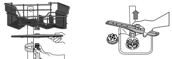
Zur Abnahme des oberen Sprüharms drehen Sie den Kunststoffring im Uhrzeigersinn ab.
