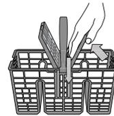
Er ist oben mit Gittern versehen, um das Besteck besser einzuordnen. Er darf nur im vorderen Teil des unteren Korbes eingesetzt werden.
